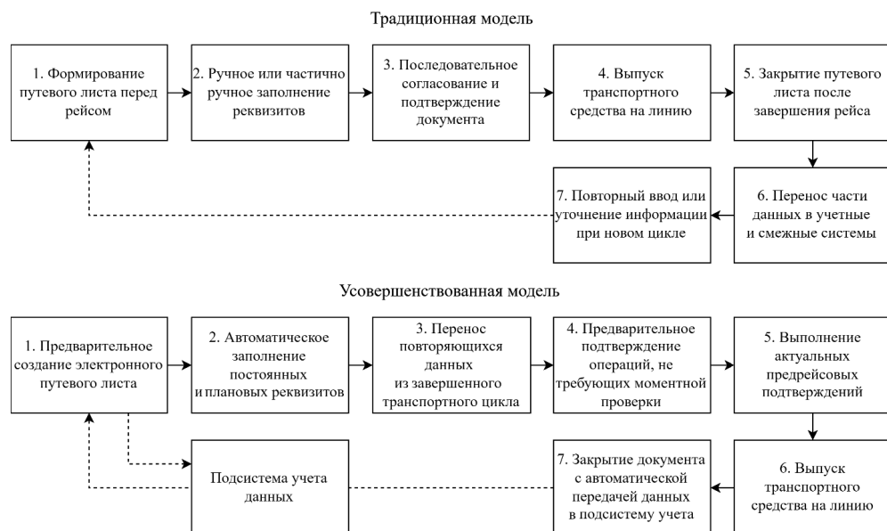
Рисунок 1 – Традиционная и усовершенствованная модели оформления электронного путевого листа в транспортном подразделении промышленного предприятия
