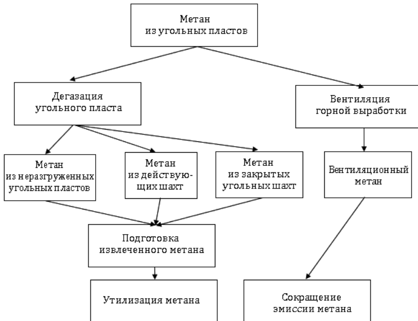
Рис. 2. Схема технологических процессов по извлечению шахтного метана и его утилизации [4]
